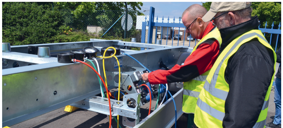
Den Manometern entgeht nichts: das Prüf-Team bei der Hub- und Senkmessung
