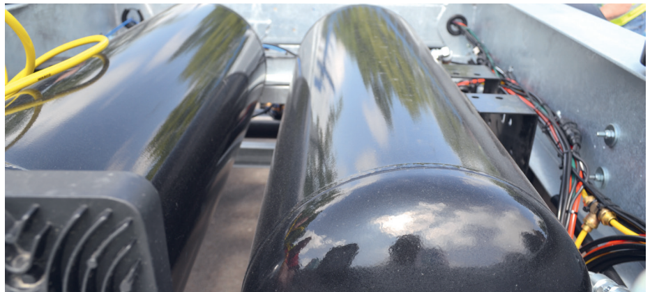
Viel Luft, viel Volumen: Insgesamt 208 l aus zwei Kesseln geben dem Anhänger einen „langen Atem“.
