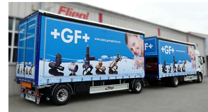
Kein Rangieren, nur ein Rampenstellplatz, kürzere Ladezeit: Mit Hilfe eines Durchladesystems können LKW und Anhänger in einem Arbeitsschritt be- und entladen werden.
