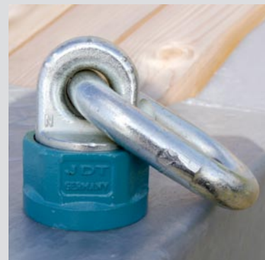
Tieflader – Zurröse geschraubt zulässige Zugkraft: 10.000 daN
