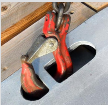
Tieflader – Zurröse eingelassen (Option) zulässige Zugkraft: 10.000 daN
