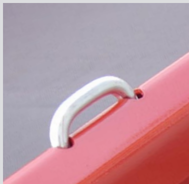
TTS – Zusätzliche Zurröse an Bordwand zulässige Zugkraft: 5.000 daN
