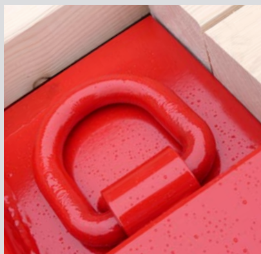
Tieflader – Zurrmulde geschweißt (Option) zulässige Zugkraft: 10.000 daN
