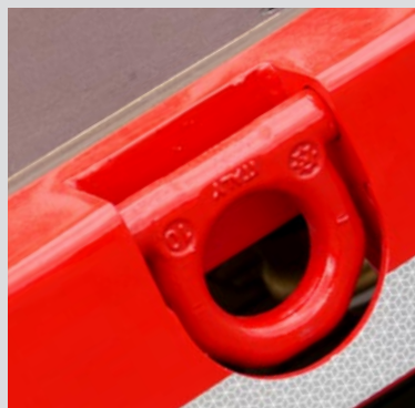
Tieflader – Schwenkzurröse (Option) zulässige Zugkraft: 10.000 daN
